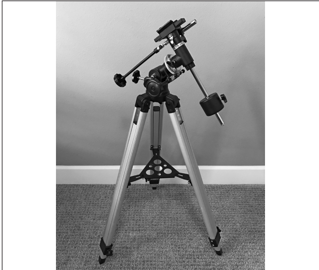
Figure 13. La monture équatoriale entièrement assemblée.
