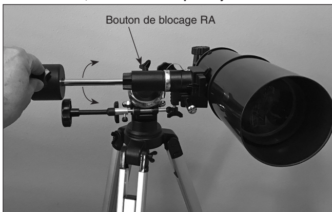
Figure 19. Équilibrez le télescope sur l'axe d'ascension droite en le positionnant comme indiqué et en faisant glisser le contrepoids jusqu'à ce que l'équilibre soit atteint.
