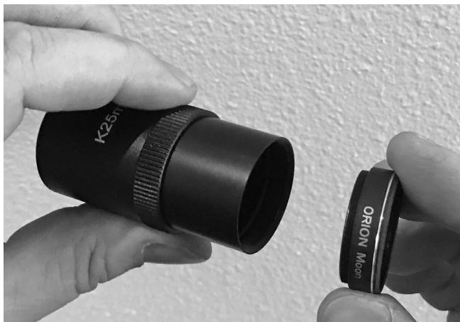
Figure 21. Les oculaires Kellner ont des barilleaux filetés pour s'adapter aux filtres optionnels Orion 1,25" (31,75 mm). Un filtre lunaire est utile pour réduire la lumière éblouissante de la Lune et révéler plus de détails de la surface lunaire.
