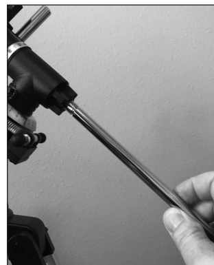
Figure 9. Introduisez la barre de contreponds dans le boîtier de déclinaison
